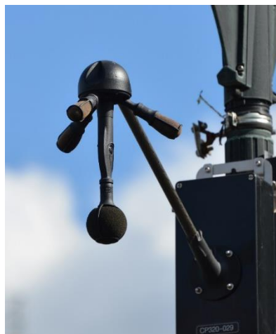
Capteur « méduse » développé par Bruitparif
